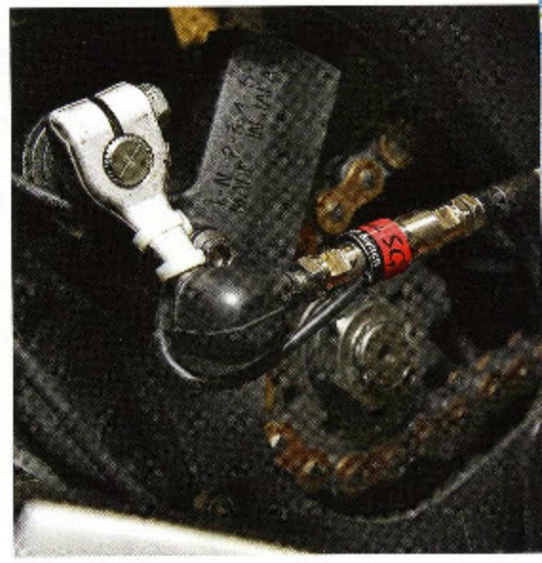
Двусторонний квикшифтер дает сигнал электронике для выполнения перегазовки при переключении передач на торможении. Срабатывание настраивается под усилие, с которым конкретный гонщик обычно давит на лапку КПП
