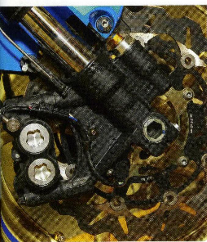
Накладной диск с окошками по периметру внутри тормозного диска служит для считывания показаний датчиком скорости вращения переднего колеса, которые используются для своей работы трекшн-контроль и другие электронные помощники
